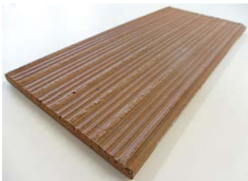
Abb. 2.1: Rückseite einer Spaltplatte 11,5 cm × 24,0 cm: Das typische Bruchbild, das durch das Spalten der Doppelplatte entsteht, begünstigt den Haftverbund der Spaltplatte am Untergrund.
