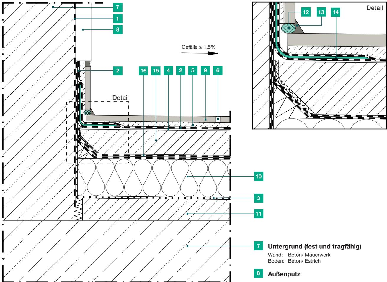
**1 Flexible Dichtschlämme nach DIN 18533**
